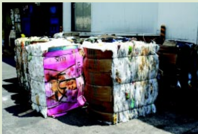
Os resíduos de isopor são transportados em fardos prensados ou em big bags com o material a granel
