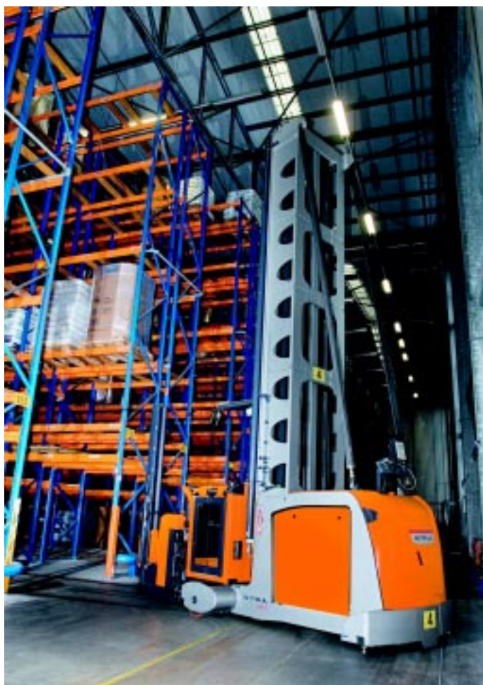
A característica básica desta máquina é que o operador sobe e desce junto com a plataforma de carga ou os garfos
