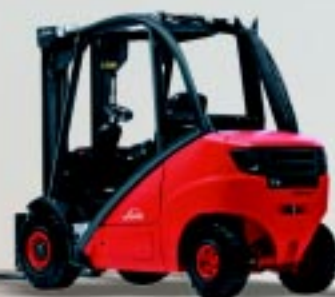
Empilhadeira GLP / Diesel H25 Capacidade de carga 2,5 toneladas
