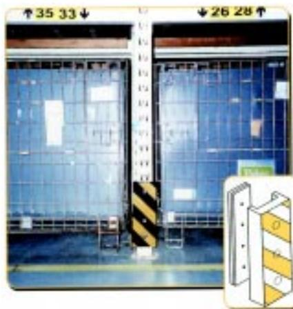
de acidente.” Segundo Simonato, os protetores de porta-paletes são desenvolvidos de acordo com cada tipo de estrutura de armazenagem. Já os protetores de docas apresentam características de absorção de impacto, sem a transmissão da onda vibratória para a estrutura de alvenaria ou do equipamento. E, finalmente, os protetores para clamps têm construção em placas de Neoplex, para proteger produtos transportados.
