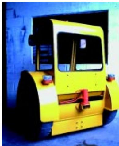
Com por cento construído no Brasil, o trator-rebocador monoeixo que está sendo lançado pela Nil Indústria de Máquinas e Equipamentos é próprio para o transporte de materiais e possui cabina dotada de sistema de ar condicionado, com renovação de ar por filtro de carvão ativado.
