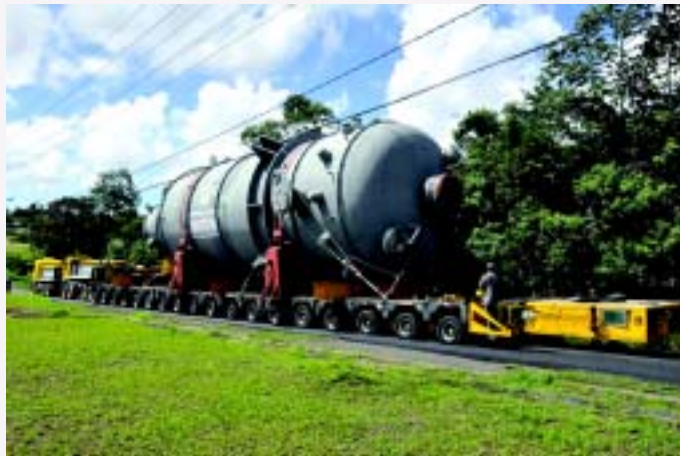
Reatores transportados pela Megatranz para a planta da Oxiteno em Camaçari, BA, pesam 473 toneladas e cada um tem 22 metros de comprimento
