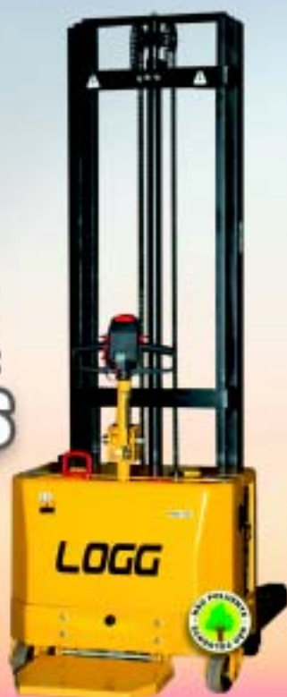
PALETEIRA ELÉTRICA COM TORRE Capacidade 1,2/1,6/2,0 t
