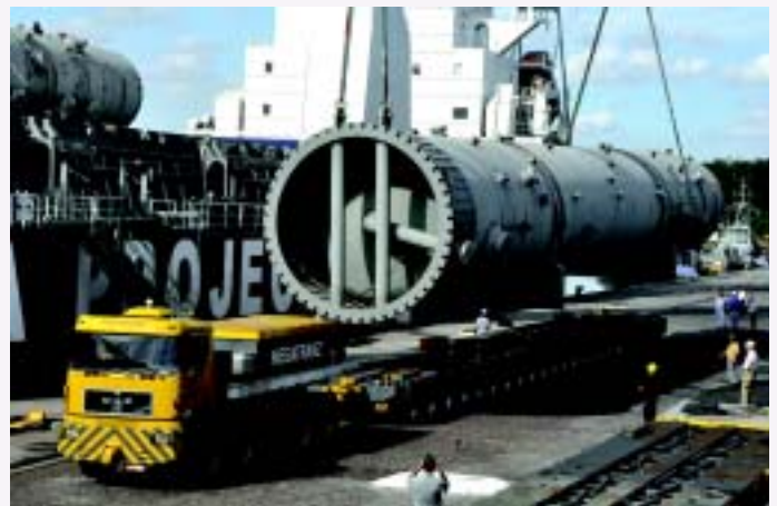
As duas colunas transportadas na mesma operação têm peso unitário de 245 toneladas e 42 metros de extensão cada uma
