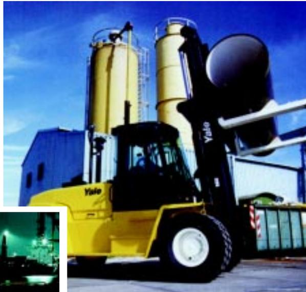
suportar imperfeições do piso. “Desta forma, as mais adequadas são máquinas com rodagem pneumática, cuja flexão dos pneus possibilitará operação mais suave.”
