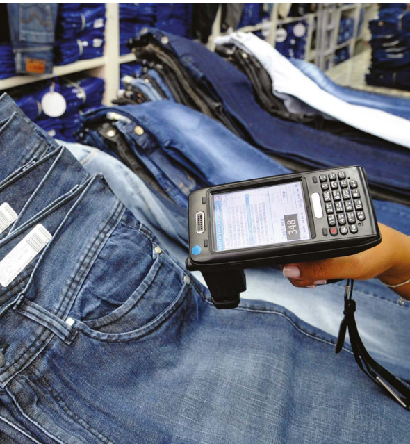
Matsubayashi , da GS1 Brasil: A TAG RFID é o dispositivo IoT de menor custo existente, isto na versão passiva, sem a inclusão de baterias e energizada pela leitora
