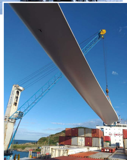
A pá de 72 metros de comprimento e 22,5 toneladas é a maior já transportada em navio portacontêiner, um recorde mundial, segundo a Aliança
