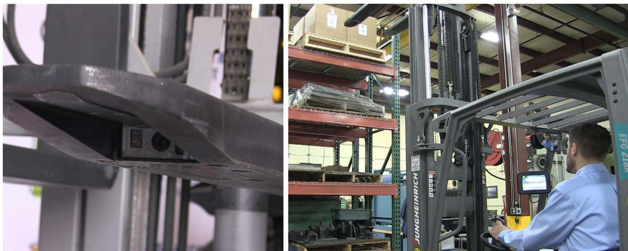
O sensor de garfos da Cascade permite ao operador ter uma melhor visão da carga, a partir de uma câmera embutida na ponta do garfo
