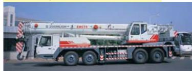
A Locar Guindastes e Transportes Intermodais (Fone: 0800 770.0618) acaba de adquirir nove unidades de guindastes, do tipo Truck Crane, da fabricante Zoomlion, modelo ZMC 75, com capacidade de 75 t. Os novos equipamentos possuem uma grande versatilidade por conterem quatro eixos direcionáveis, facilitando manobras dentro das obras.
