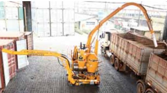
tipo de equipamento realiza a estufagem ou a desova de grãos de forma limpa e direta, é móvel e multiuso. A operação é realizada do veículo para o contêiner, ou do contêiner para o veículo, sem contato do produto com o solo ou mistura com outros lotes, o que garante a qualidade
