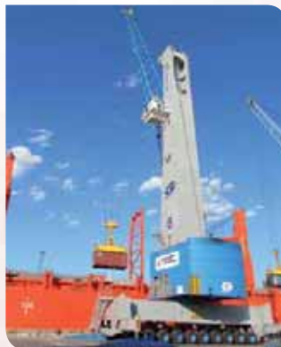
O novo guindaste é direcionado ao carregamento e descarregamento de contêineres, granéis e carga geral em pequenos e grandes navios. Tem capacidade para movimentar contêineres de 20 a 200 toneladas
