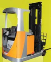
Capacidade de carga 2000 kg e elevação de até 11.975 mm
