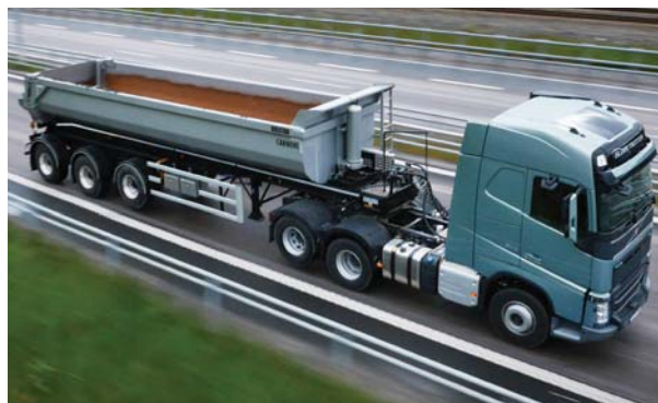
Com o suspensor de eixo ligado, o segundo eixo motriz do caminhão 6x4 é desativado e as rodas são elevadas, diminuindo o arrasto e perdas mecânicas
