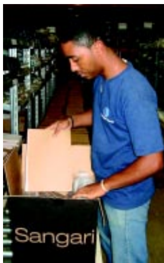
A empresa utiliza caixas de material corrugado com paredes duplas, para garantir uma boa armazenagem e empilhamento
