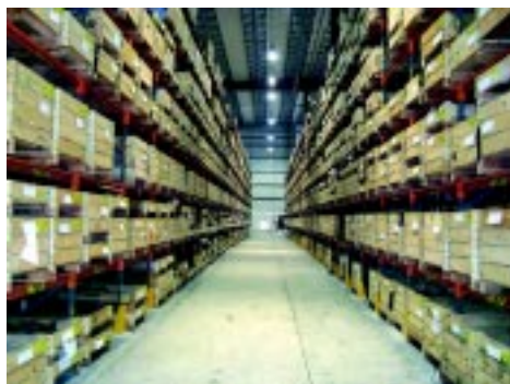
Na Iveco são utilizados portapaletes com até 7,60 m altura x 1,20 m profundidade x 1,70 m largura
