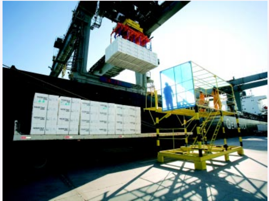
Para exportação, os fardos de celulose são colocados diretamente dentro do porão de navios break bulk
