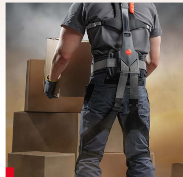
Hunic: SoftExo Lift, exoesqueleto passivo, para auxílio de levantamento e transporte
