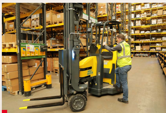
Combilift: Aisle-Master OP, equipamento que combina as vantagens de uma empilhadeira para corredor estreito com as de uma selecionadora de pedidos, com altura de elevação de 12,1 metros e capacidade de carga de duas toneladas
