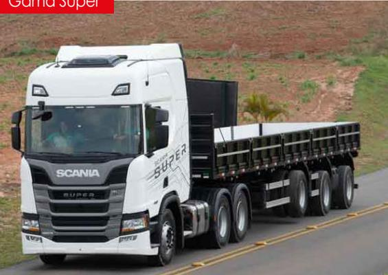
Com os motores Euro 6 (até 2% de economia de diesel) e a gama Super (até 8% de redução de consumo e novo trem de força), a linha 2023 de caminhões agrega novas potências, duas novas gerações de caixas de câmbio (G25 e G33) e redução de emissões de material particulado, óxidos de nitrogênio (NOx) e CO<sub>2</sub>. Já na garantia da disponibilidade estão as melhorias nos produtos com o aumento dos intervalos de troca e de manutenção, os Serviços Conectados
