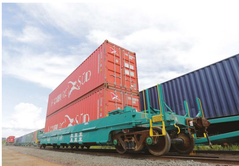
Os vagões podem carregar até três contêineres empilhados: um de 40 pés e dois de 20 pés
