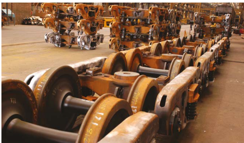
Os truques, responsáveis pela dinâmica e estabilidade dos vagões, são produzidos através de parceria com a Amsted Rail
