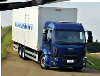
O Cargo 2429 é um dos destaques da linha, com capacidade máxima de tração de 38.000 kg
