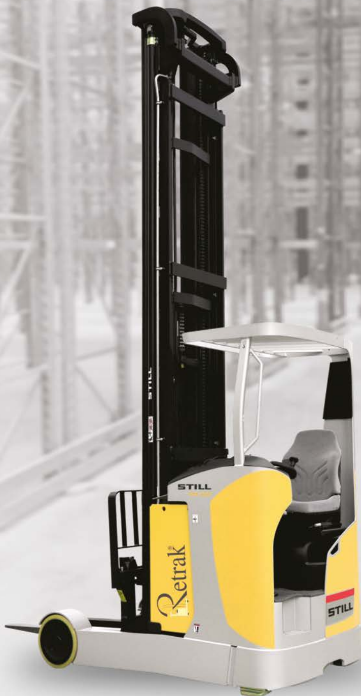
Empilhadeira elétrica retrátil 2,0t
